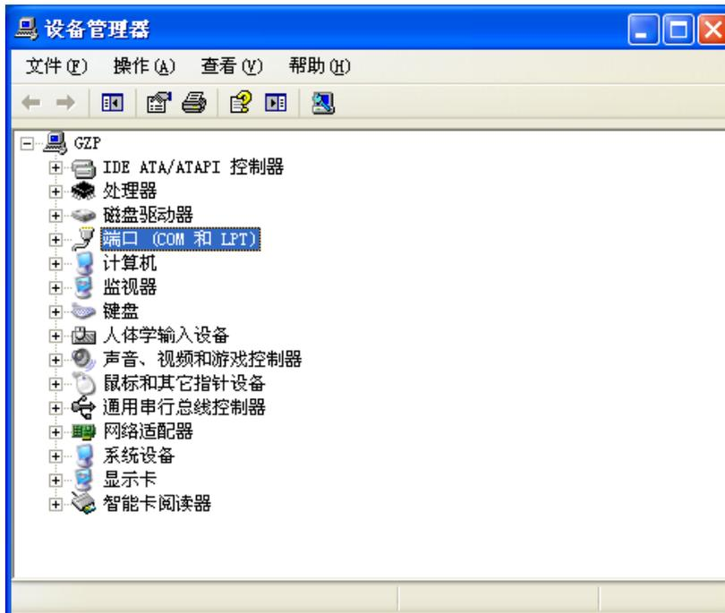
10、 SG72A 为 USB 通信接口，所以在设备管理器中会显示为“USB serial port(COM[x])”，图中在设备管理器查看到的端口为 COM3(根据电脑的不同，会显示不同的 COM 口，如可能显示为 COM4、COM5、COM6 等)。当前操作步骤如下图所示：
