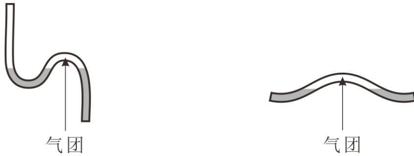
图6 错误的管道连接方法
