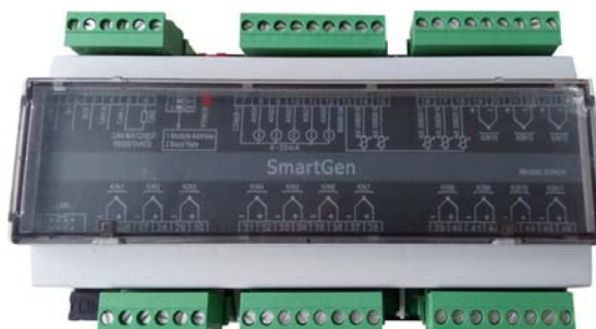
图13 AIN24 为模拟量输入模块，包括 14 路 K 型热电偶输入，5 路 PT100 输入，5 路 4-20mA 电流输入。
