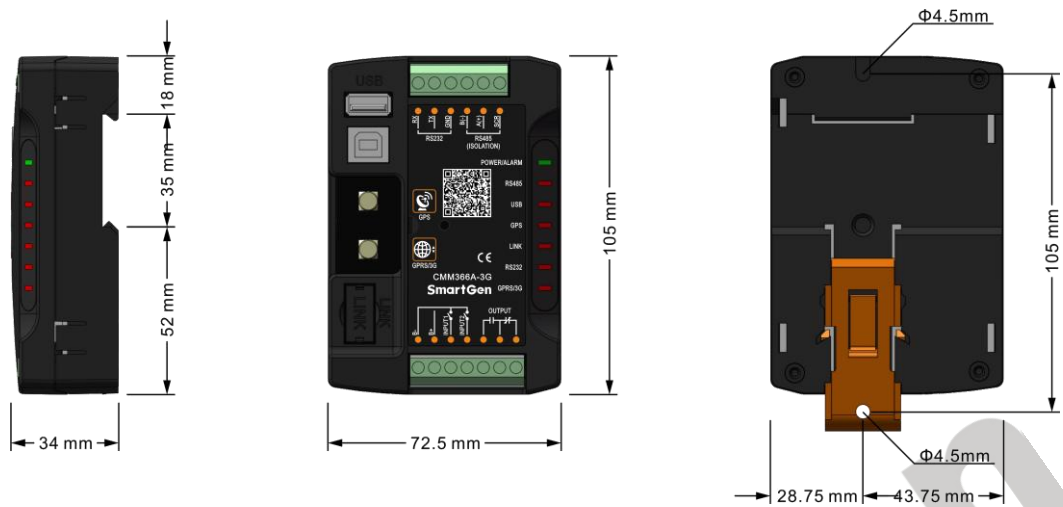
图11 CMM366A-3G 外形尺寸图
