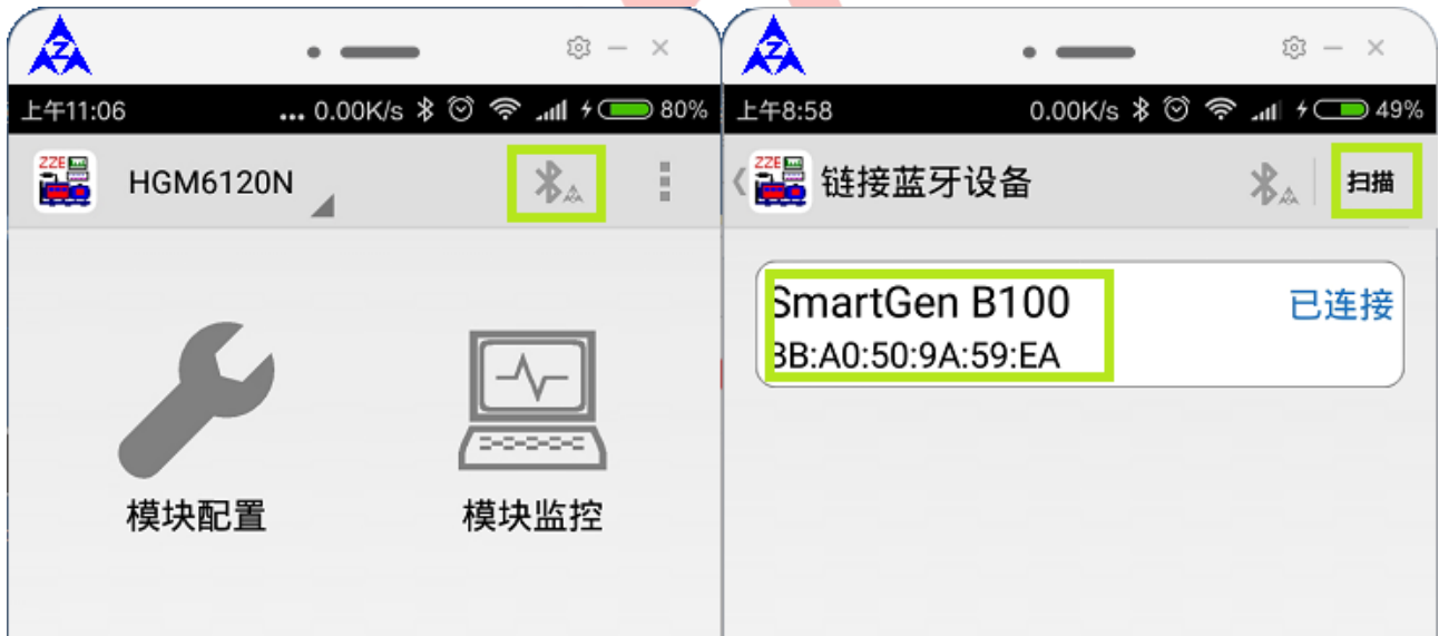
图4 连接蓝牙模块
