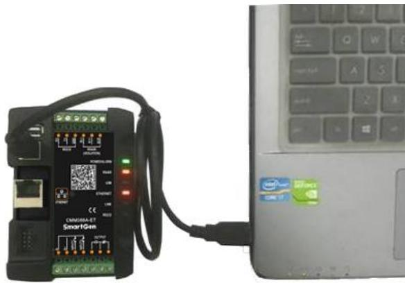
图7 USB 与 PC 配置连接示意图
