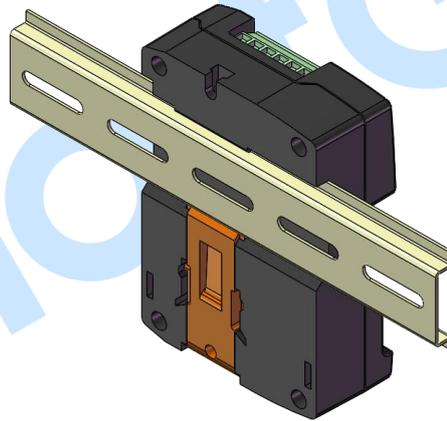
图13 CMM366A-ET 导轨安装方式
