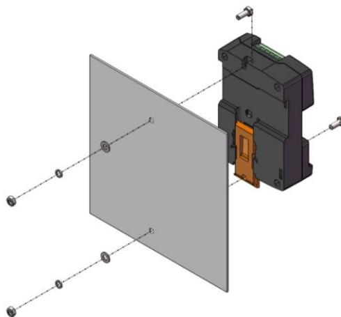
图14 CMM366A-ET 螺丝安装方式
