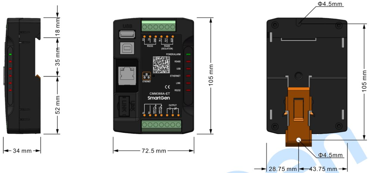
图12 CMM366A-ET 外形尺寸图
