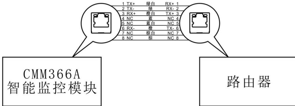
图2 以太网与路由器连接示意图
