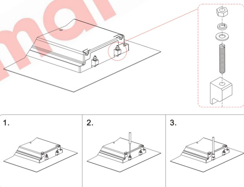
图11 ACC7100A 卡件安装示意图
