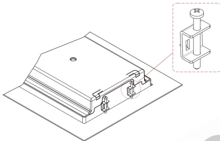
图10 ACC7100 卡件安装示意图
