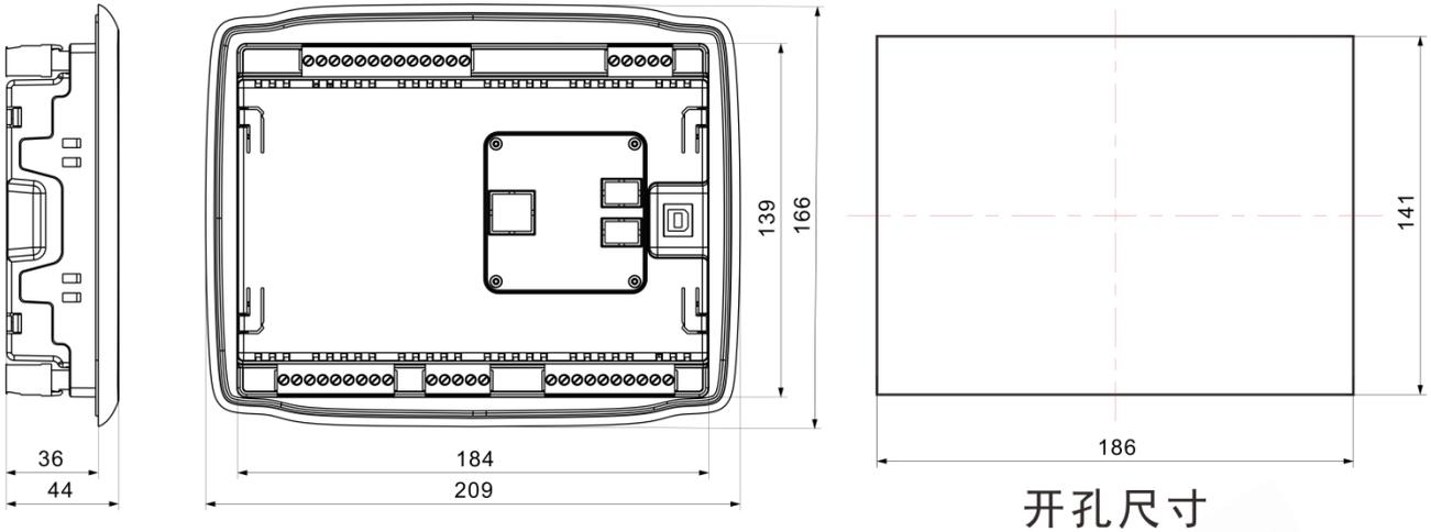
图12 ACC7100 外形及开孔尺寸
